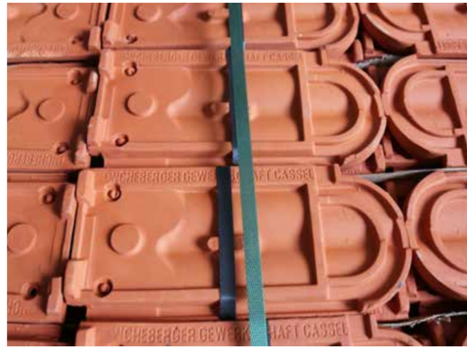
▲ Die Ziegel wurden daher nachgeprägt und in einer Kleinserie gefertigt
