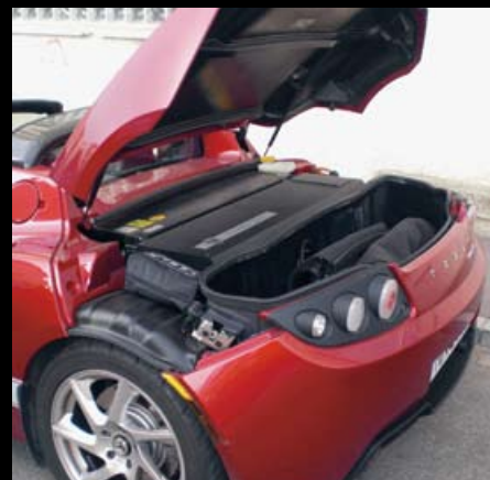
▲ Hinter dem Fahrer geht's heiß her: 6831 Standard-Akkus bilden die Energiezentrale, die schon mal auf Temperaturen kommt
